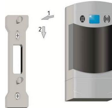
Рисунок 2 – Установка извещателя
