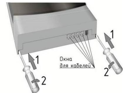
Рисунок 3 – Снятие крышки клеммного отсека
